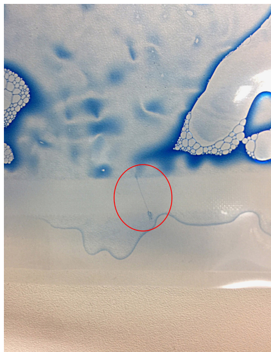
Abbildung: ASTM F3039-15 Standard Test Method for Detecting Leaks in Nonporous Packaging or Flexible Barrier Materials by Dye Penetration – Beispiel für eine undichte Stelle in einer Siegelnaht. Mit Hilfe des Kapillareffektes dringt das Färbemittel in die undichte Stelle ein.
