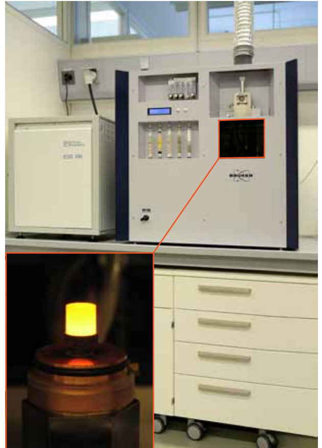
Abbildung: Trägergasschmelzextraktions-Analysator mit gekoppeltem Massenspektrometer. Vergrößerter Ausschnitt: glühender Graphittiegel (ca. 2700 °C).
