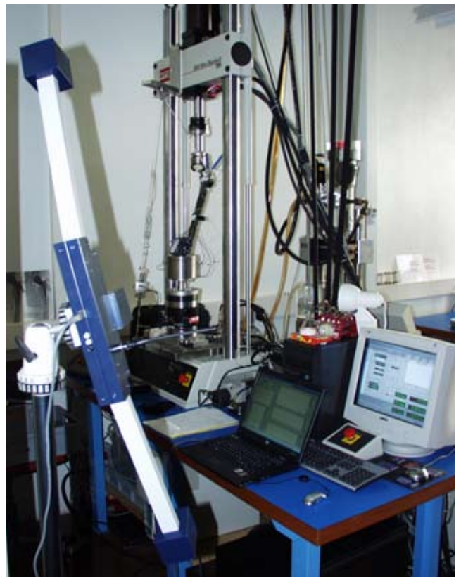
Abbildungen: Testaufbau für den Funktionstest von periprothetischen Implantaten (Übersicht und Detail).
