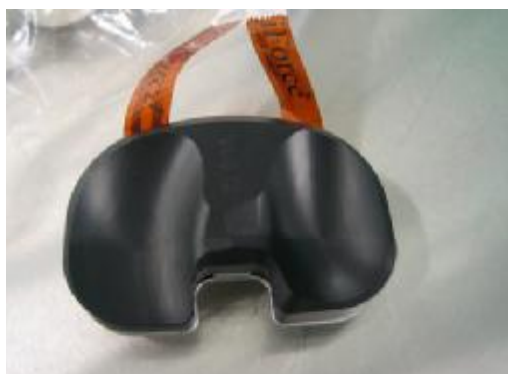
Abbildungen: Instrumentierte Tibiakomponente mit zwei Tekscan Kraftsensoren.
